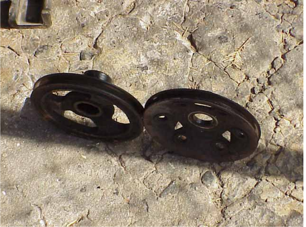
Poleas del damper (izquierda) y la adicional para el mover el compresor del A/C (derecha).
