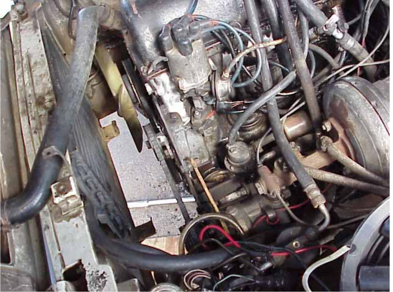
Base del compresor ya fijada al motor y sus correas instaladas.
